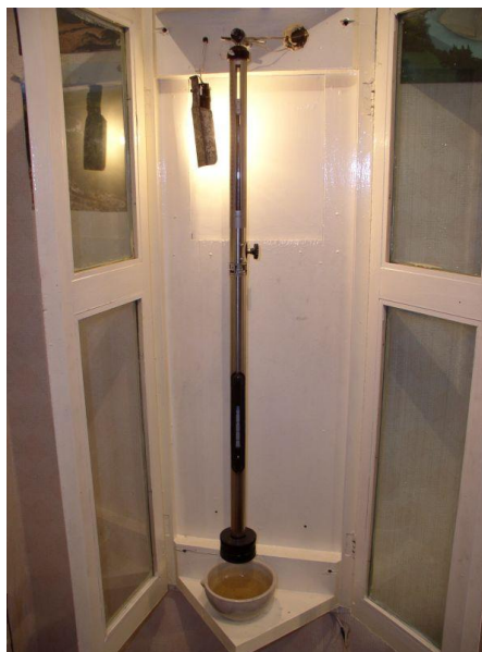
Рис.6. Чашечный ртутный барометр
